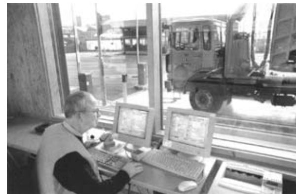
Abb. 1: Schenck-Straßenfahrzeugwaage beim Entsorgungsbetrieb im Datenverbund
