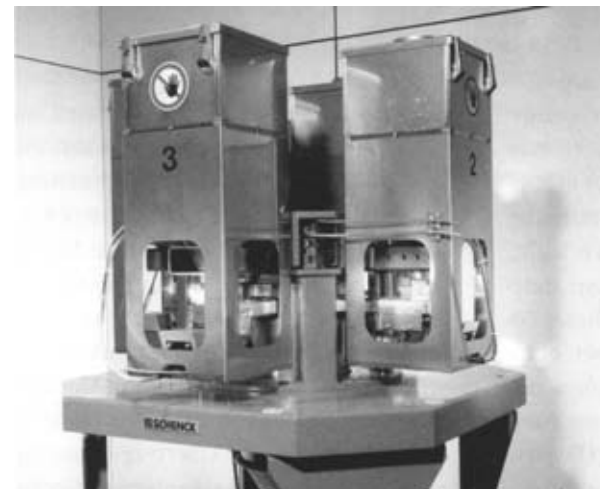
Abb. 2: Extruderbeschickung über MULTIGRAV Mehrkomponentendosierer mit Ethernet-Anschluss
