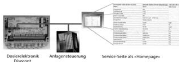
Bild 6: Dosiervogel mit Ethernetanschluss und Homepage
