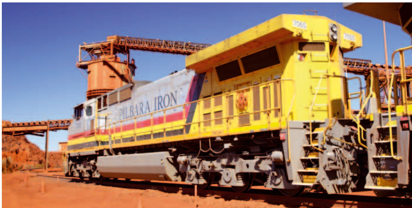
Die Züge bestehen aus bis zu 234 Waggons und werden vorne von drei Lokomotiven und hinten von zwei weiteren Lokomotiven angetrieben. Trains can comprise up to 234 ore cars, with three locomotives at the front and two at the rear.
