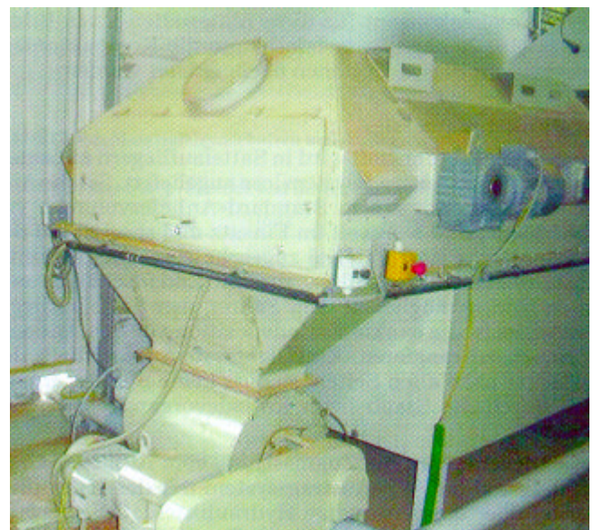
BILD 5: Dosierbandwaage mit Durchblassechleuse FIGURE 5: Weighfeeder with air-lock rotary-vane feeder
